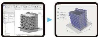
CADECTで、Revitデータを簡易空間モデル化し、不足情報を追加設定したり、独自に1から簡易空間モデルを作図することができます。簡易空間モデル上で間取の変更や建具の幅の伸び縮み、断熱仕様変更時の検討作業が行えるため、設計検討に活用できます。
